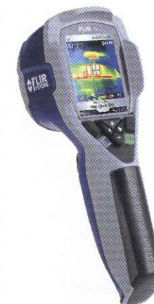
Fot. 5. Ultralekka kamera termowizyjna, fot. Flir
