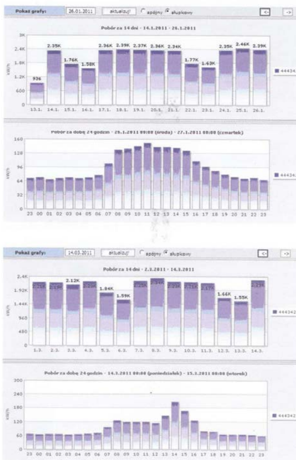
Rys. 3. Grafik obciążeń z rozliczeniowego licznika energii elektrycznej budynku. Wykres górny pokazuje dane za 2 tygodnie stycznia 2011 r., a dolny – obciążenie godzinowe z doby 26 stycznia 2011 r.
