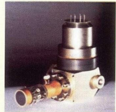
Rys. 3.1. Matryca detektorów podczerwieni oraz widok miniaturowego zespołu chłodzenia (z zamontowanym detektorem)
